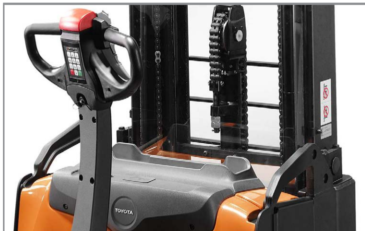
Рукоятка оптимизирована для безопасной работы и защищает ноги оператора от наезда
