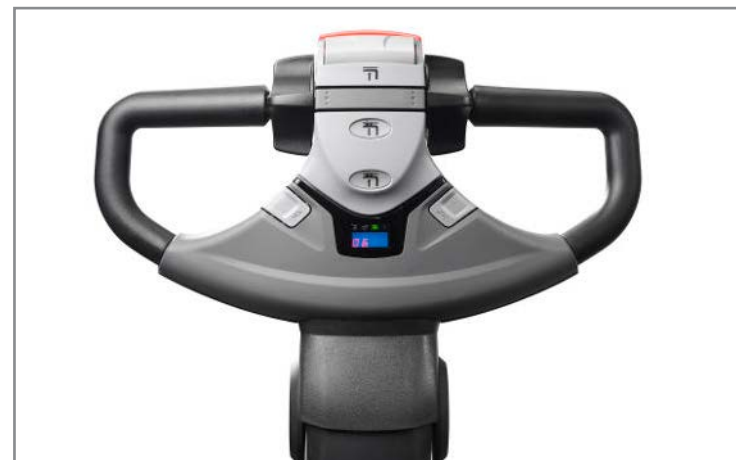
Эргономичный рычаг управления с аварийной кнопкой безопасности
